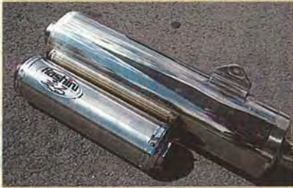
David und Goliath: Suzuki-Serien- und Hashiru-Dämpfer im Vergleich. Das Volumenverhältnis beträgt rund 3,5:1
