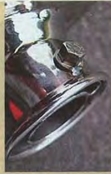
Vorbildlich: Beim BOS-Topf sichert ein Schweißpunkt das geschraubte Endröhrchen – auch dB-Eater, Noise-Killer oder ähnlich genannt – vor unbefugtem Entfernen
