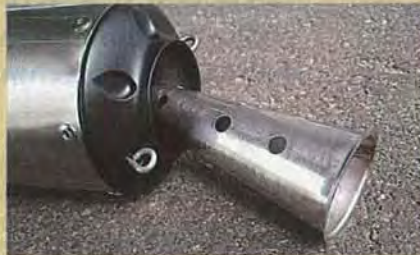
Gut versteckt: Beim GPR sitzt die leicht entfernbare Flöte zwischen Verbindungsrohr und Dämpfer
